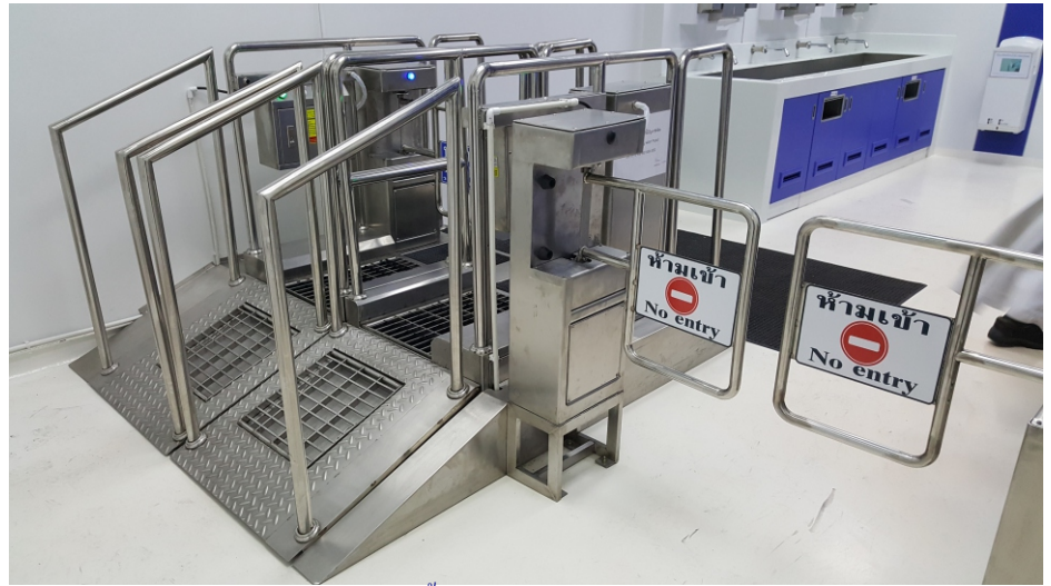
ติดตั้ง CB Vneo-80uplusAutoG2 และออฟชั่นเสริม แบบเปียก +ทางขึ้นลงลาดชัน+แขนกันทางเข้าออก
